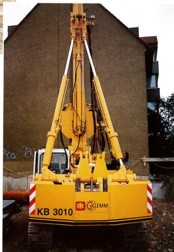
Hinteransicht der KB 3010 mit Hydraulischer Mastabstützung und Kellywinde.
