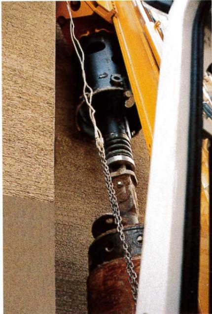
Bohrgetriebe H 90 mit Drehteller, Bohrrohrmitnehmer, Kellystange und Schnecke von 700 mm Ø.
