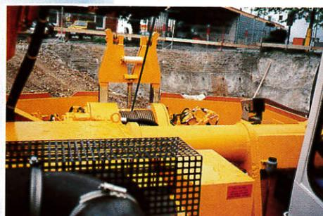
Seilspulung der Kellywinde und Kontrolle über TV-Kamera.
